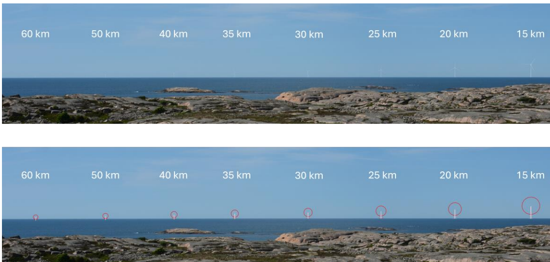
Figur 7-10. Figuren visar genom fotomontage hur ett 370 meter högt vindkraftverk upplevs på varierande avstånd (15–60 kilometer). Sikten är klar och betraktaren står 28 meter över havsnivån. De röda cirklarna i nedre bilden representerar rotorbladen. Bild från Bilaga 10.
