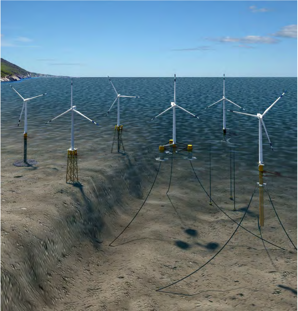
FIGUR 23 Översikt av fundamenttyper för havsbaserade vindkraftverk. Källa: Illustration Joshua Bauer, NREL 49055.
