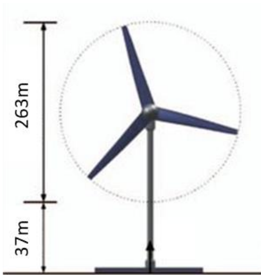
Figur 3. Figuren visar vindturbinernas storlek i den preliminära produktionsanalysen. Totalhöjden är 300 m.
