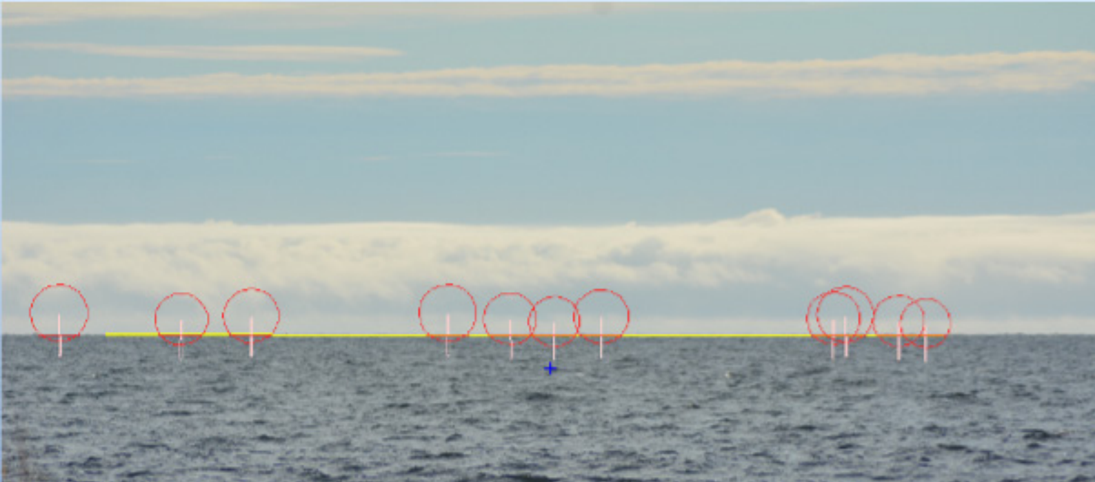
FIGUR 21 Siktlinjeanalys av ovanstående fotomontage. Den del som ligger under den gula horisontlinjen är gömd bakom horisonten och de röda linjerna visar turbinernas svepta yta.
