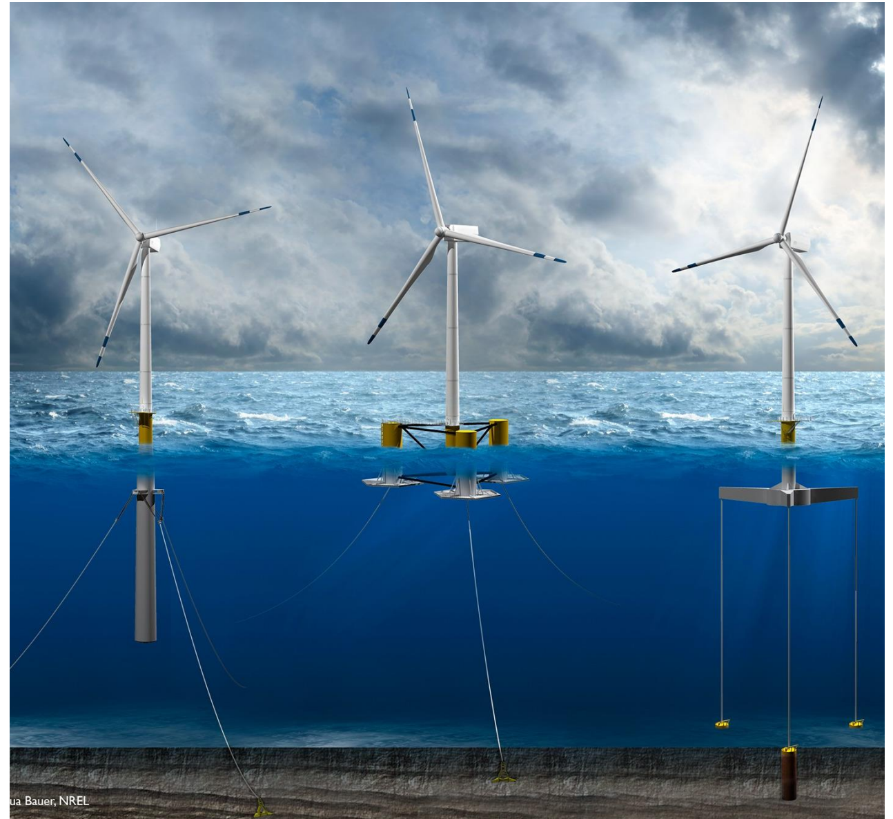
Figur 12. Exempel på flytande fundament som kan bli aktuella inom Skagerrak Offshore Gamma. Från vänster: Spar, Semi-Submersible, Tension leg. Illustration: Joshua Bauer, National Renewable Energy Laboratory (NREL).
