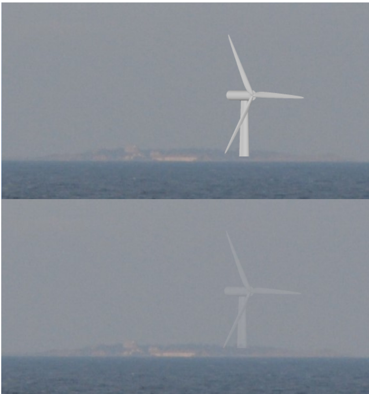
Figur A4: visualisering av en turbin placerad på Christiansø 21km från observationspunkten med 105mm objektiv samt kraftig digital förstoring. Den övre bilden visar turbinen synbarhet utan någon hänsyn till siktreduktion på stora avstånd. Den nedre bilden visar synbarheten med föreslagen siktreduktion.
