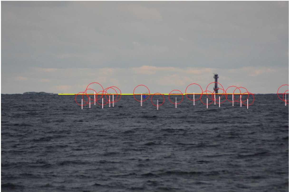
Figur 5: visuell analys baserat på samma foto som nedre bilden i 7. I denna analys är turbinerna representeras av röda cirklar samt ritas in framför havet fast de egentligen ligger skymda bakom havets krökning. Av denna analys ser man att de närmaste turbinerna sticker upp ca 140m ur havet ((den del som ligger över horisonten), men pga det långa avståndet är det väldigt svårt att se turbinerna i figur 8.
