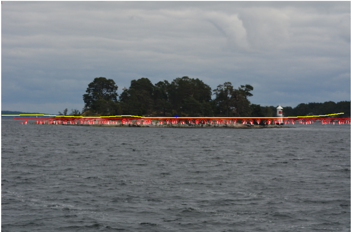
Figur 6: teoretisk visuell analys från observationsplats B. I denna analys är turbinerna representeras av röda cirklar framför den skymmande terrängen. Foto taget med 70mm objektiv.
