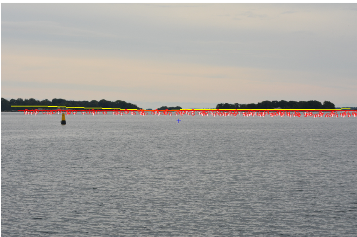
Figur 9: teoretisk visuell analys från observationsplats E. I denna analys är turbinerna representeras av röda cirklar framför den skymmande terrängen. Foto taget med 70mm objektiv.
