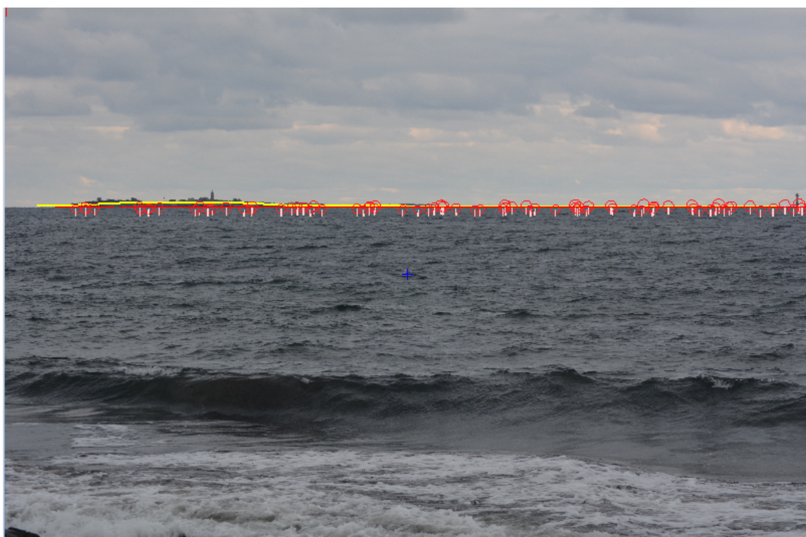
Figur 3: visuell analys baserat på samma foto som 5. I denna analys är turbinerna representeras av röda cirklar samt ritas in framför havet fast de egentligen ligger skymda bakom havets krökning. Av denna analys ser man att de närmaste turbinerna i högra delen av bilden sticker upp ca 140m ur havet ((den del som ligger över horisonten), men pga det långa avståndet är det väldigt svårt att se turbinerna i figur 5.
