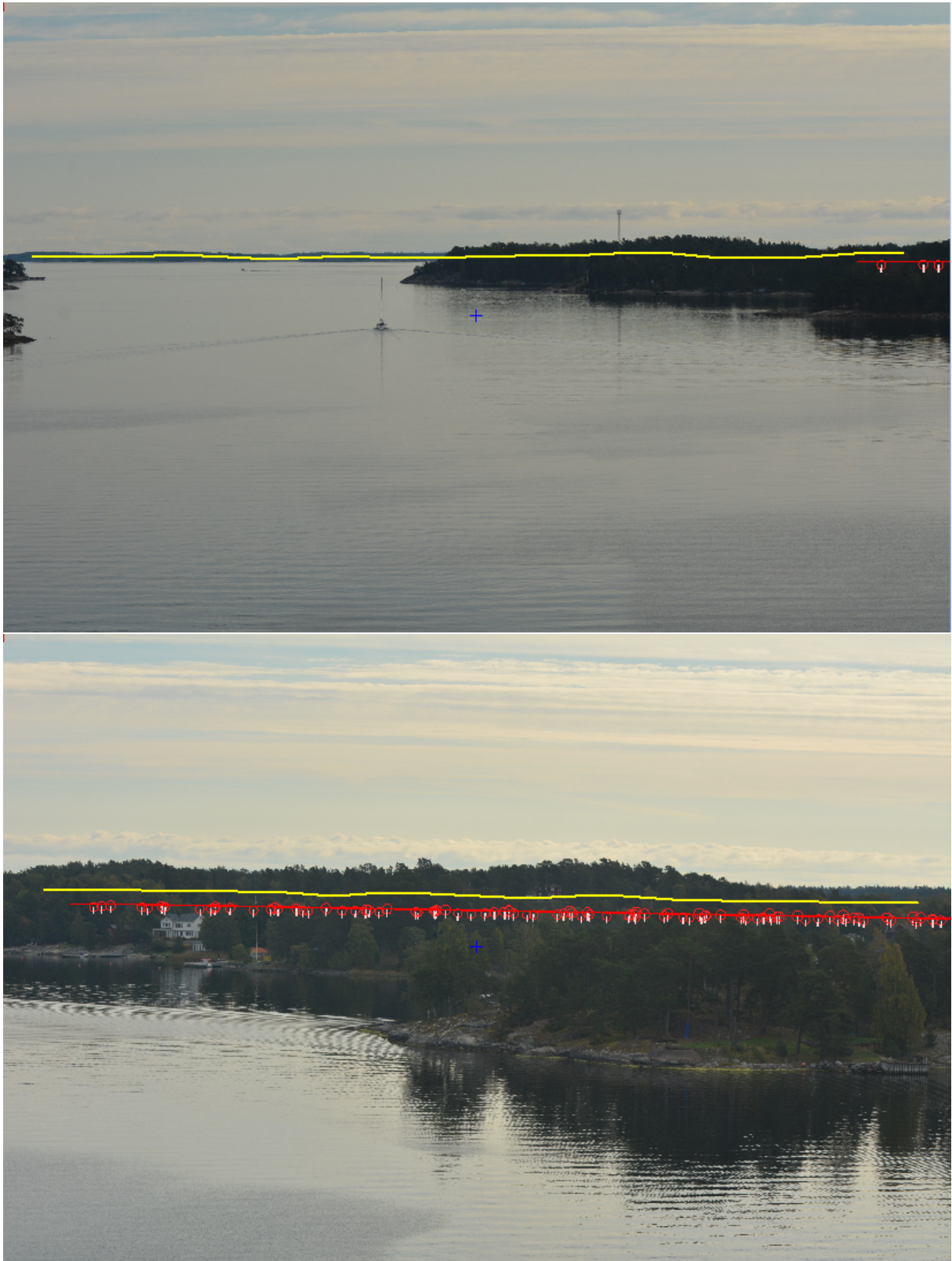
Figur 7: teoretisk visuell analys från observationsplats C. I denna analys är turbinerna representeras av röda cirklar framför den skymmande terrängen. Övre bild är tagen i nordostlig riktning och undre bild i östlig riktning. Båda fotona är tagna med 70mm objektiv.
