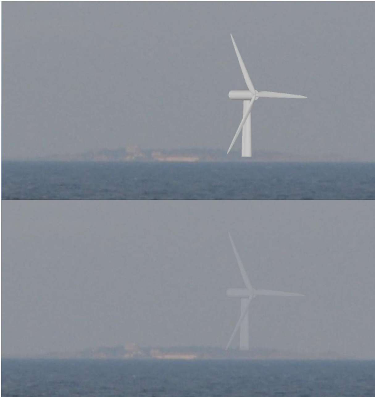
Figur 4. Visualisering av en turbin placerad på Christiansø 21km från observationspunkt B med 105mm objektiv samt 10 gånger digital förstoring. Den övre bilden visar turbinen synbarhet utan någon hänsyn till siktreduktion på stora avstånd. Den nedre bilden visar synbarheten med föreslagen siktreduktion.
