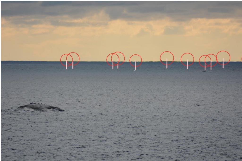
Figur 52. Siktanalys baserat på samma foto som nedre bilden i Figur 48. I denna analys är turbinerna representerade av röda cirklar samt ritats in framför havet fast de egentligen ligger helt eller mestadels skymda bakom havets krökning. Analysen visar att det är teoretiskt möjligt att se övre halvan av de närmaste vindturbinerna, men pga. det stora avståndet är det i praktiken väldigt sällan turbinerna syns från fotopunkten, se Figur 48.
